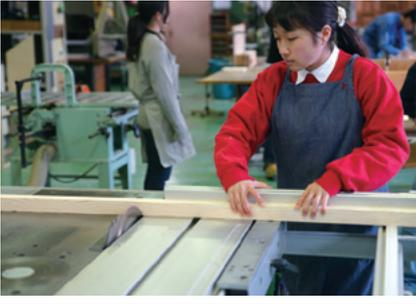
木工は、材料となる木材を運んだり、機械を使うにしてもしっかりと材料を押さえたりと、基本的には筋力が必要な作業です。力の弱い女性には不向きな作業なのですが、それをできるだけ補うような工夫もされています。設備の選択もその一つ。操作に力が必要な設備は切り替えられ、ボタンで操作できるようなものが設置されています。集塵設備なども改善され、扱いやすくなっています。
