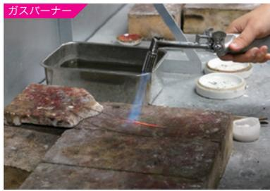
銀ロ一付け、ガス溶接などを行う。小さなものであれば、素材を溶かして型に流し込み線材に成形することもできる
