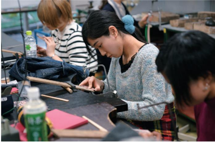
メタル&ジュエリーデザインコース、2年生の授業にお邪魔しました。デザイン学部の場合、1年のファンデーションでデザインを総合的に学び、2年になって専門コースを選択します。そのため2年の授業では、もっとも基本的なこと、道具（糸のこ・ヤスリ・ロール・バーナー）などの使い方、金属の性質と加工方法を学びます。行われていた授業は、半期で銅板透かし（糸のこを使って地金に描いた模様を切りそこに模様を加える）、すり出しリング（シルバーの角棒を曲げて形を作り、ヤスリで模様をすり出す）、ロストワックス技法によるリング制作（ワックス（ロウ素材）で指輪の原型を作り鑄造する）の三つの課題に取り組みます。
