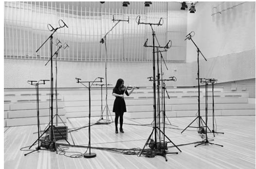
写真4. 13組の AB Stereo DPA 4006A と、1組のバウンダリーマイク、Schoeps BLM03C
