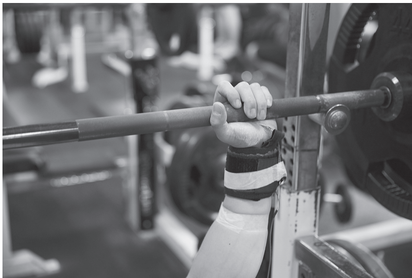
図3 手掌圧部を測定する S&ME 社製フットセンサー(DL-250)を装着してシャフトを握っている様子
