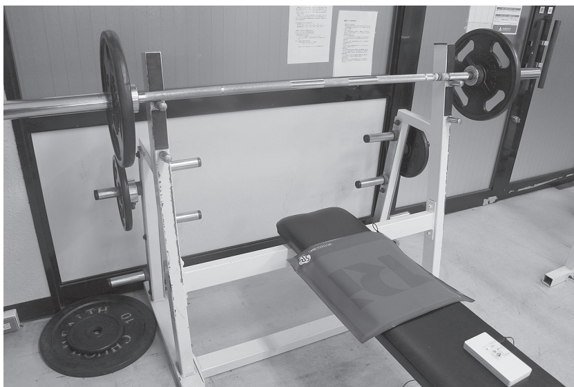
図2 ベンチプレス台に設置したSRソフトビジョン(数値版)のセンサーシート
