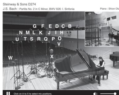
写真2 ピアノの録音におけるマイク配置の比較音源 <http://soundmedia.jp/nuaudktua/>
